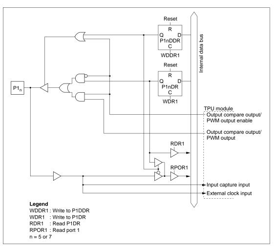
Figure C.1 (d) Port 1 Block Diagram (Pins P1<sub>5</sub> and P1<sub>7</sub>)
