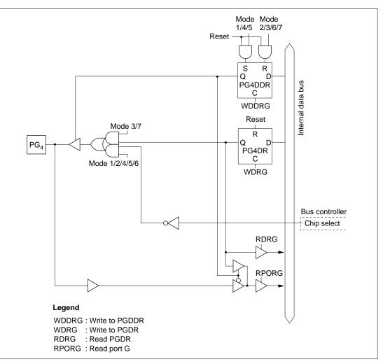
Figure C.11 (d) Port G Block Diagram (Pin PG<sub>4</sub>)
