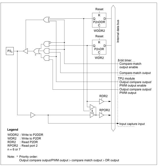
Figure C.2 (d) Port 2 Block Diagram (Pins P2<sub>6</sub> and P2<sub>7</sub>)
