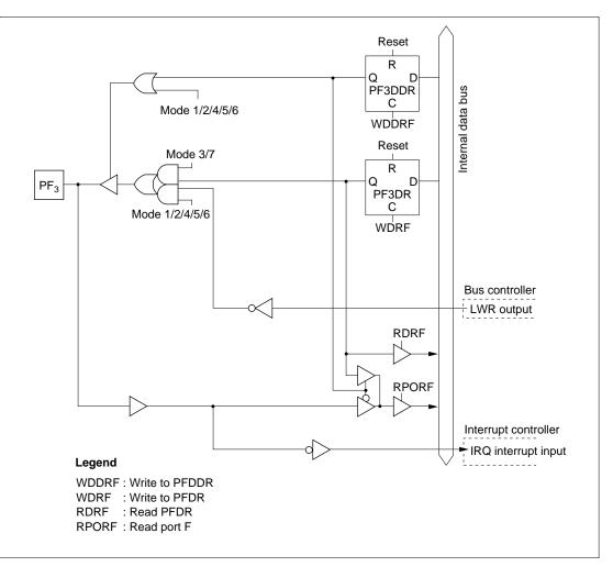
Figure C.10 (d) Port F Block Diagram (Pin PF<sub>3</sub>)
