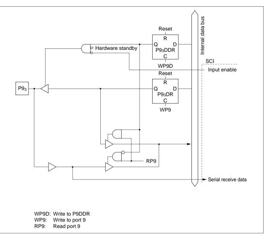
Figure C.9 (d) Port 9 Block Diagram (Pin P9<sub>3</sub>)
