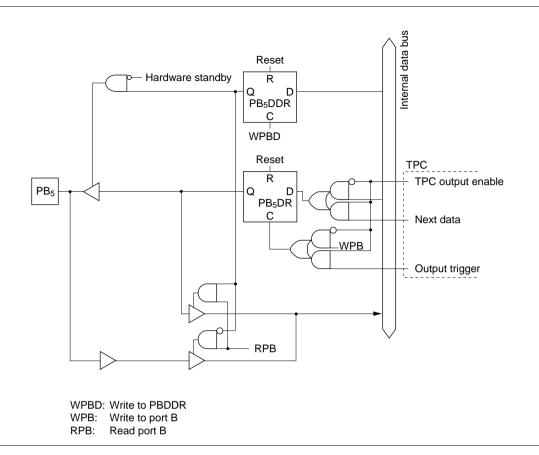
Figure C.11 (d) Port B Block Diagram (Pin PB<sub>5</sub>)
