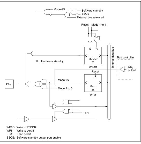
Figure C.8 (d) Port 8 Block Diagram (Pin P84)
