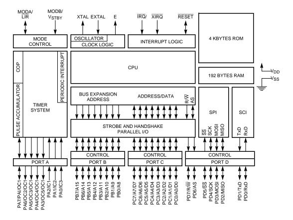
Figure 1-1 MC68HC11D3 Block Diagram
